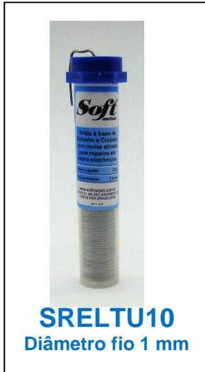
3) **Modo de usar:** utilizando o ferro de soldar ou estação de solda: aquecer o componente e o local a ser soldado. Colocar o fio de solda sobre o componente e aguardar até que a solda escorra. Deve-se evitar de encostar o fio de solda diretamente na ponta do ferro de solda. O fluxo interno irá fundir primeiramente e poderá e espirrar no soldador.
