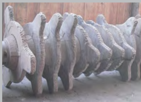
Tecnologia ε3 após 37 meses, o rotor ainda está em boas condições.
