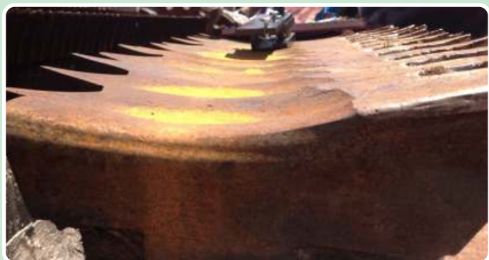
Bagaceira com revestimento convencional de CCr. Perda de perfil do corpo e dentes. Impacto direto na extração
